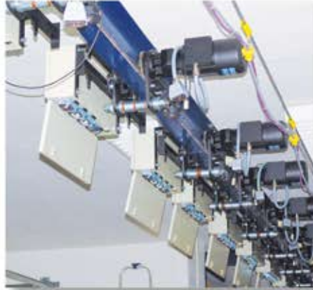
Teststand für Fahrwerke Test Facility for Trolleys
